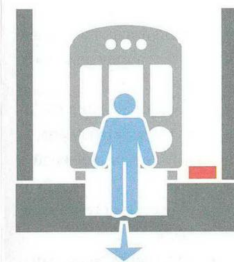
Идите вдоль полотна между рельсами, не прикасаясь к токоведущим шинам (**сбоку от рельсов**), во избежание поражения электрическим током
